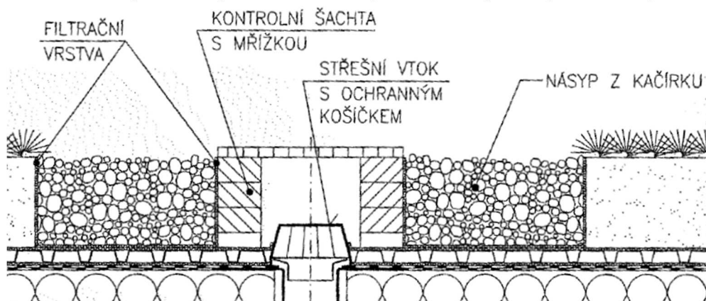
Obrázek 1 –Detail střešní vpusti [zdroj: ČERMÁKOVÁ Barbora a Radka MUŽÍKOVÁ. Ozeleněné střechy. Praha: Grada, 2009. Stavitel. ISBN 978-80-247-1802-6.]
